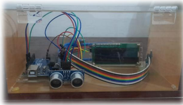
Gambar 2. Tampak Alat Pendeteksi Objek Berbasis Sensor Ultrasonik HC-SR04 dan Mikrokontroler Arduino Uno R3
