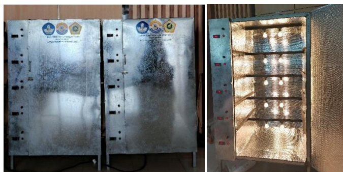
Gambar 1. Teknologi alat pengering bedak dingin yang dihibahkan kepada mitra
